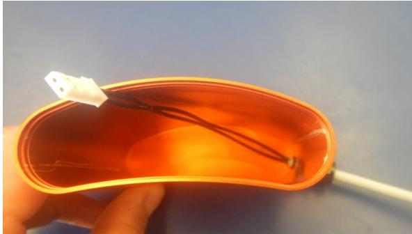
Das graue Kabel nur soweit durch die Durchführung ziehen, dass es ganz knapp sichtbar ist! Und dann die Durchführung satt (aber nicht übermässig!) anziehen – kein Teil darf sich nachher noch bewegen.
