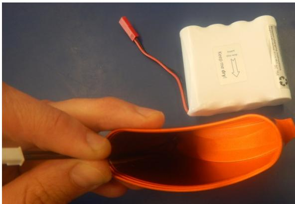
Jetzt die beiden schwarzen Litze gegen die Gehäusewand drücken und den Akku so einsetzen wie es der kleine Aufkleber auf dem Akku anzeigt (also ‚umgekehrt‘).
