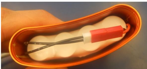
Die Kabel sind so abgemessen, dass dann der Stecker mühelos verbunden werden kann und das Akkugehäuse ist tief genug, so dass der Akkufachdeckel perfekt passt 😊
